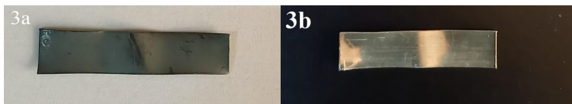
Slika 3 - Srebrne pločice nakon testa korozije ASTM D 1275-15 na ulju pre tretmana (3a) i nakon tretmana (3b)
