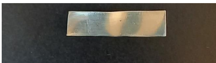
Slika 7 - Izgled srebrne pločice nakon testa korozije ASTM D 1275-15 nakon završenog tretmana ulja na pilot-postrojenju.
