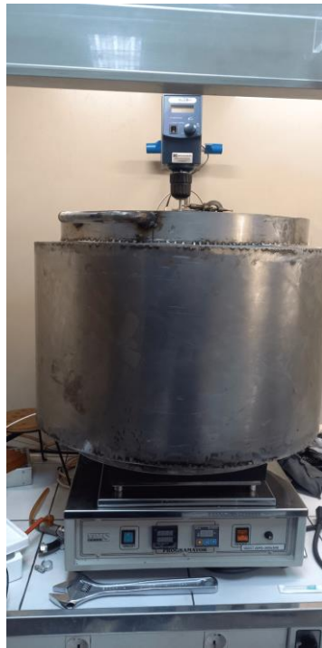
Slika 5 - Pilot postrojenje za uklanjanje S 8 iz mineralnog izolacionog ulja
